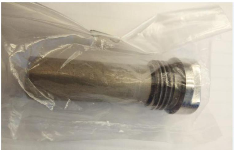
Разрушенный ( использованный ) модуль
